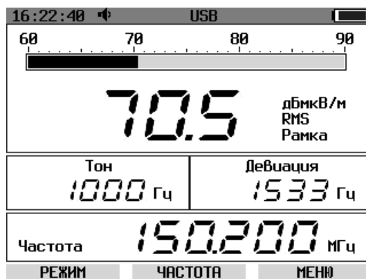
Рис. 2. Режим измерения напряжённости поля и параметров модуляции
