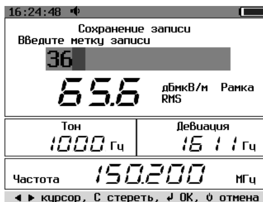
Рис. 6. Ввод километровой метки при сохранении результата измерений
